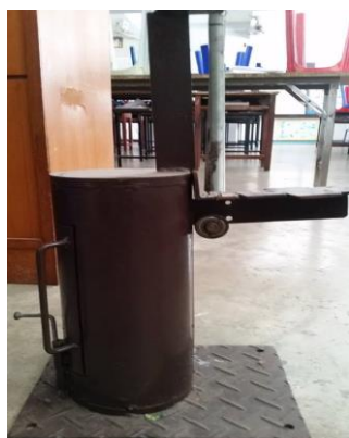
ภาพที่ 8 แสดงเครื่องบีบอัดขวดพลาสติกกึ่งอัตโนมัติ
