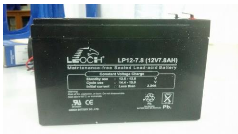
ภาพที่ 3 แสดงแบตเตอรี่แบบแห้งขนาด 12 V 7.8 AH
