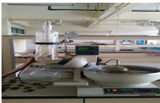
ภาพที่ 7 แสดงการระเหยของเอทานอลและเอซีโตนด้วยเครื่อง Evaporator
