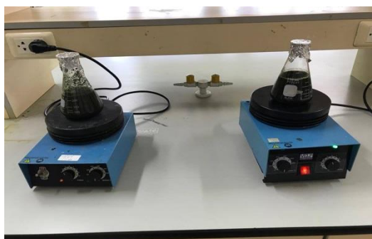
ภาพที่ 6 แสดงการแยกแทนนินด้วยเครื่อง magnetic stirring
