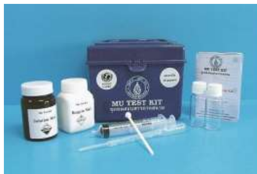
ภาพที่ 14 แสดงชุดการทดสอบออกซิเจนภาคสนาม
