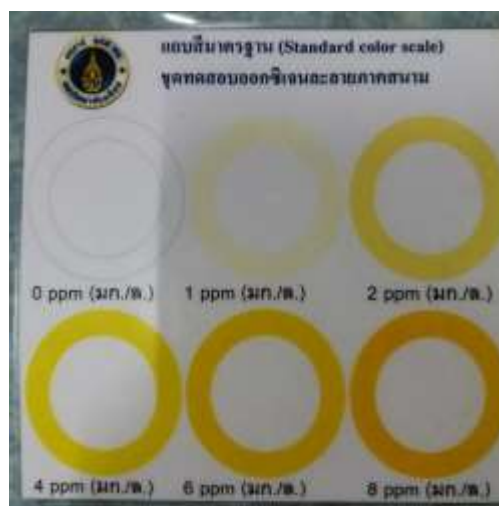
ภาพที่ 15 แสดงแถบสีมาตรฐานในชุดทดสอบออกซิเจนละลายภาคสนาม
